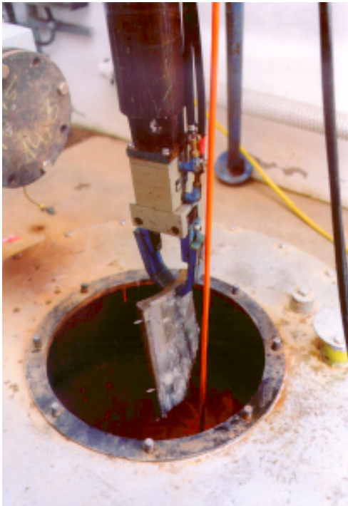
Bergung eines Stücks OBO-Schale mittels eines Pneumatikgreifers aus 150m Tiefe
